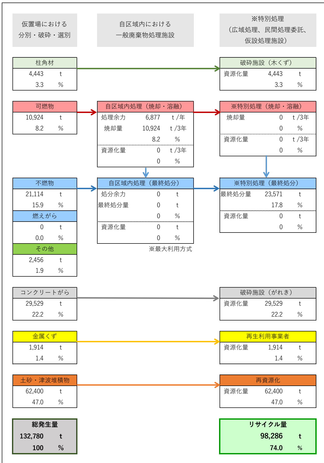
図10 南海トラフ巨大地震での災害廃棄物処理フロー (例) 津波堆積物を含む
