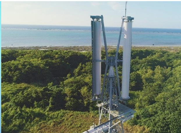
図 5-11 垂直軸型マグナス式小型風力発電機
