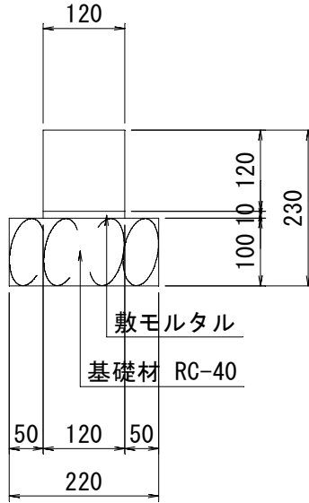
地先境界ブロック構造図 S=1:10 地先境界ブロックA
